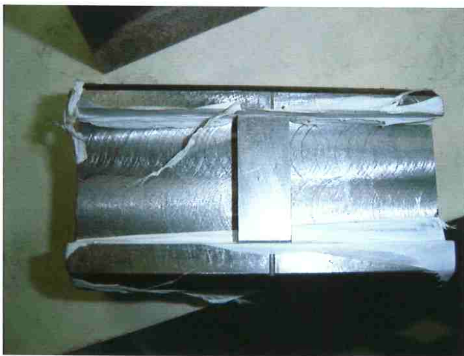
Figura A1 – Matriz de Base com o corpo de prova e a fita de Teflon
