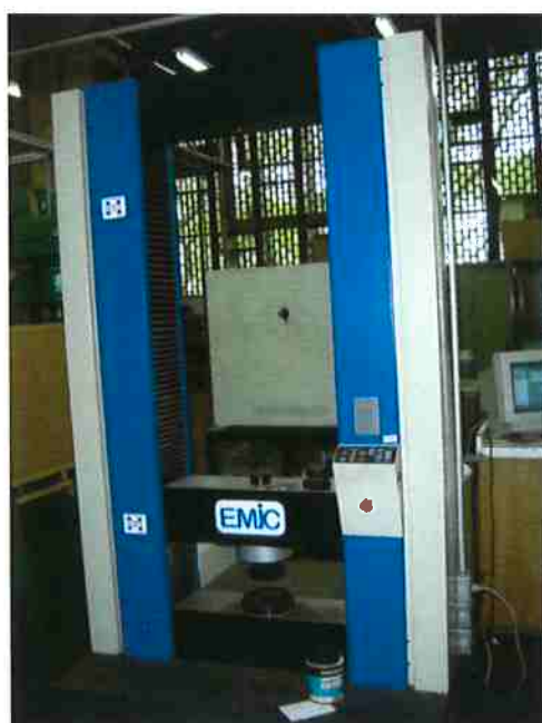
Figura 4.3 – Máquina de ensaios EMIC DL30000 com capacidade para 300kN
